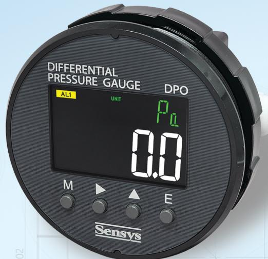
DPOモデルは、非腐食性ガスに使用でき、微差圧、真空圧力およびゲージ圧力が測定できるため、空調システムに適します。前面サイズは100mmで、93mmの取付穴に固定して使用できます。出力タイプは、4~20mA（2線式）出力モデル（4桁バックライトLCD）とその他の出力モデル分かれています。特に、その他の出力モデルはカラーディスプレイLCDを採用して、視認性が優れていますし、絶縁型RS485出力により、安定した使用が可能です。
