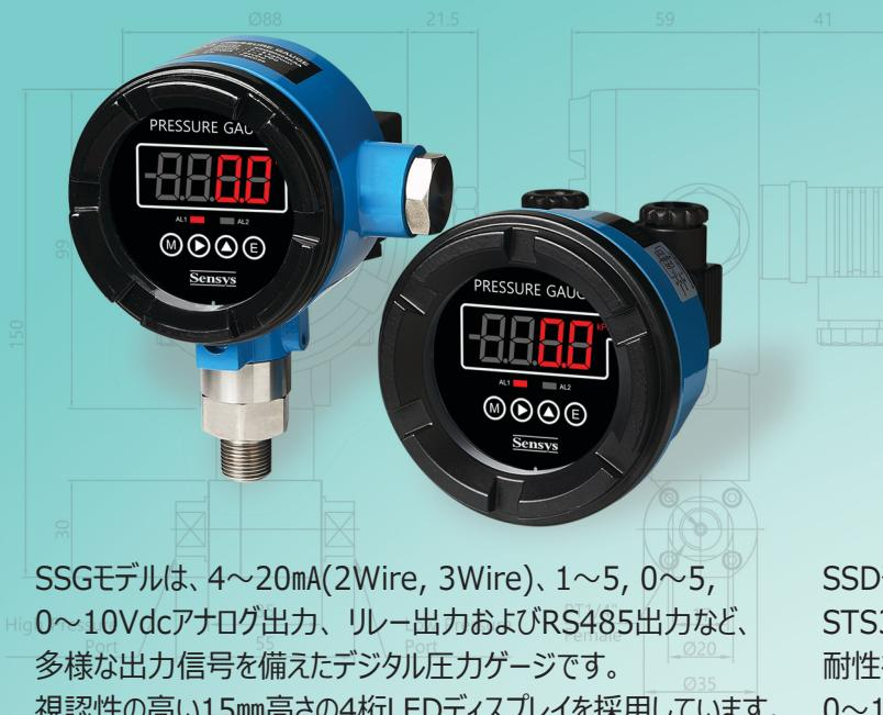
SSGモデルは、4~20mA(2Wire, 3Wire)、1~5, 0~5, 0~10Vdcアナログ出力、リレー出力およびRS485出力など、多様な出力信号を備えたデジタル圧力ゲージです。視認性の高い15mm高さの4桁LEDディスプレイを採用しています。IP65構造のアルミニウムケースで製作されており、環境条件に制約がありません。
