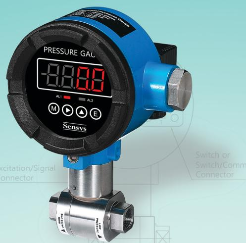
SSDモデルは、精密な差圧測定に適して、接液部の材質がSTS316Lで作られているため、腐食性物質に対し優れた耐性を持っています。4~20mA(2Wire, 3Wire)、1~5, 0~5, 0~10Vdcのアナログ出力、リレーアラーム出力、RS485出力など、多様な出力信号を提供します。視認性の高い15mm高さの4桁LEDディスプレイを採用します。IP65構造のアルミニウムケースで製作されているため、環境条件に制約がありません。
